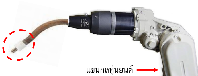
(ค) หัวเชื่อมสำหรับการเชื่อมอัตโนมัติ สำหรับลวด FCAW-S
