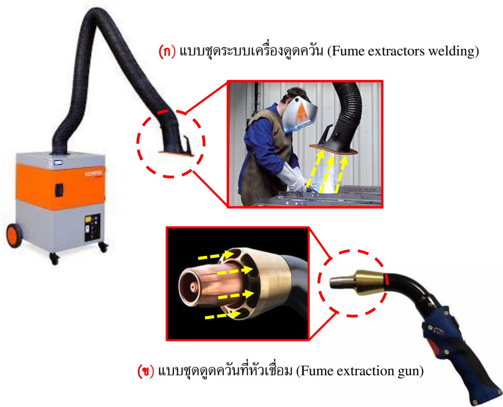
รูปที่ 3.66 ระบบการดูดควันที่เกิดจากการเผาไหม้ของฟลักซ์ในการเชื่อมลวดไส้ฟลักซ์
