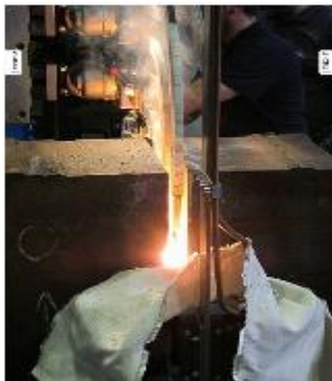
(ค) ระบบการประคองน้ำโลหะเหลว
