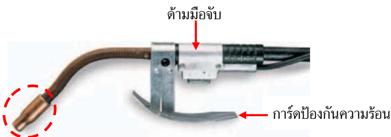
(ข) หัวเชื่อมสำหรับลวดเชื่อมแบบ FCAW-G
