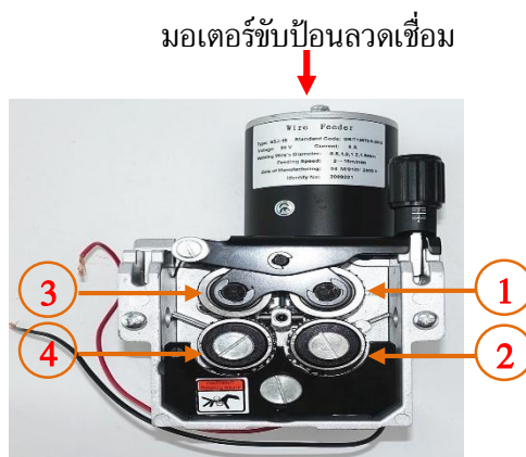
(ข) ชุดระบบล้อขับป้อนลวดเชื่อม แบบชนิด 4 ล้อ (2 คู่)
