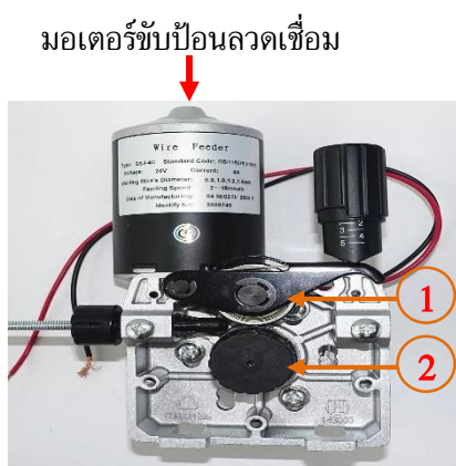
(ก) ชุดระบบล้อขับป้อนลวดเชื่อม แบบชนิด 2 ล้อ (1 คู่)
