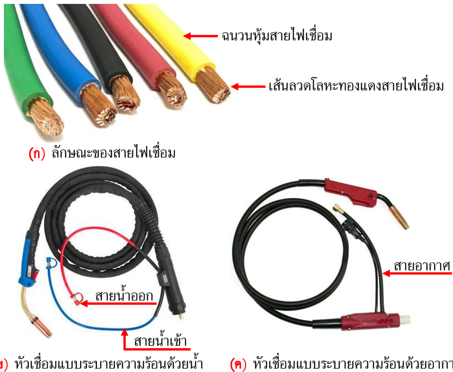
รูปที่ 3.43 ลักษณะของสายไฟเชื่อม และหัวเชื่อมที่ระบายความร้อนด้วยระบบน้ำและระบบอากาศ
