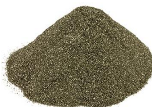
(ก) ผงฟลักซ์ชนิดหลอม “Fused powdered fluxes”
